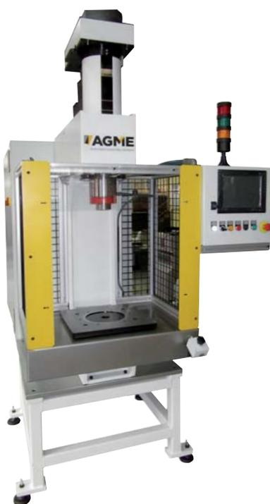
Las servo prensas AGME serie PE tienen **multitud de aplicaciones** en procesos de ensamblaje de componentes y otros procesos relacionados: unión, inserción, prensado, doblado, remachado, rebordeado, punzonado, clinchado, test, control y marcado.
